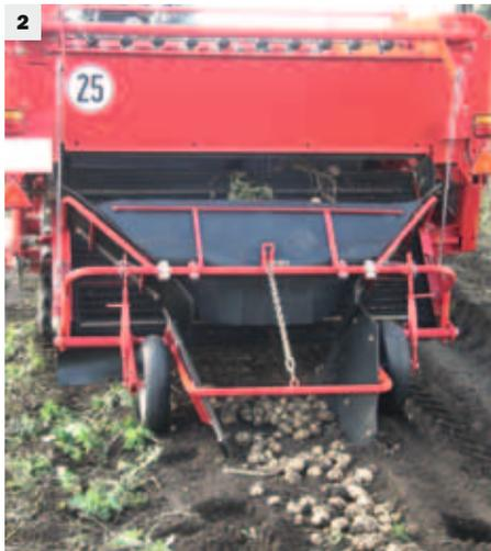
WR 200 с длинным просеивающим транспортёром укладывает картофель в валок шириной 130 см (1). После этого идёт ручная уборка.
