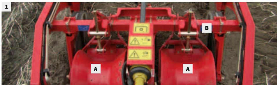
Высокий технологический стандарт: все копатели производства Grimme оснащены роторным подбивальщиком (2), регулируемым по интенсивности механическим путём.
