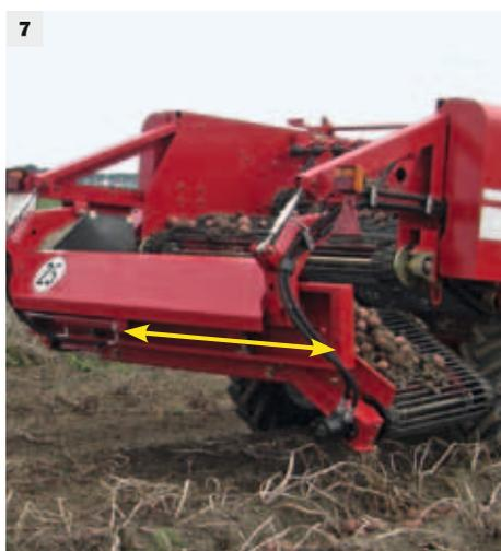
С помощью встряхивателя (6) осуществляется особенно бережная сепарация на первом просеивающем транспортёре. Опционально возможна бесступенчатая (электрическая) регулировка интенсивности встряхивателя.
