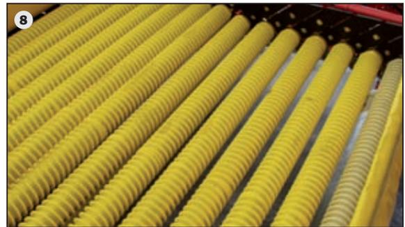
Для достижения лучших результатов отделения примеси и сортировки: используя фракционирующее оборудование с количеством до 14-ти полиуретановых спиральных вальцев (7+7 вальцев) возможна как эффективная и щадящая сортировка, так и максимальная очистка продукции при предельно бережном отношении к ней, даже в самых сложных условиях.
