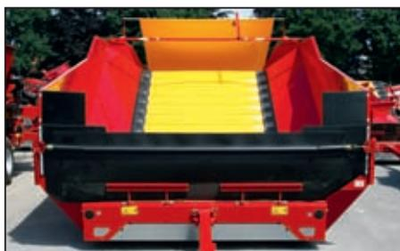
*Множество преимуществ одновременно: изгиб в конце дна бункера растягивает поток продукта, улучшает равномерную передачу продукта на секцию землеотделяющих валцов и обеспечивает непрерывное заполнение последующих машин.*
