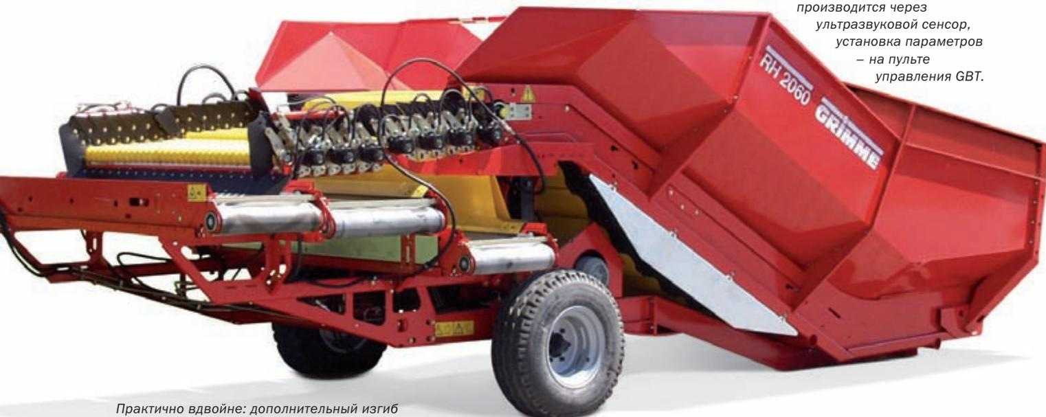
Практично вдвойне: дополнительный изгиб в нижней части донного транспортера бункера не только увеличивает его объем, но и исключает опасность повреждения дна бункера высокими подвижными бортами.
