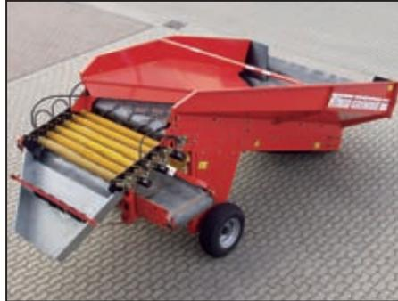
Огромные преимущества: с помощью большой засыпной воронки для RH 16-40 (без выравнивающей рейки на бункере) Вы можете дополнительно увеличить объем бункера с 4 до 5,5 м<sup>3</sup>.
