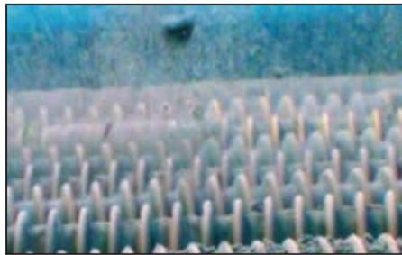
Отличная очистка: в качестве допоснащения возможно оборудование системой быстрой очистки вальцов TURBO-CLEAN. С помощью максимального числа оборотов вальцов и возникающей при этом центробежной силы производится тщательная очистка вальцов. -Идеальное решение для липких почв.
