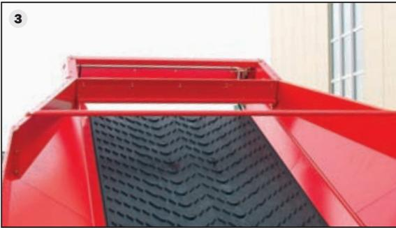
Для равномерного потока: выравнивающая рейка на бункерах RH 16-40, RH 16-40 E и RH 12-40 E делает равномерным поток продукта и обеспечивает оптимальную загрузку последующих машин.
