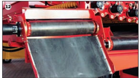
Мягкое падение и осторожная укладка продукта в контейнер: с помощью амортизатора падений.
