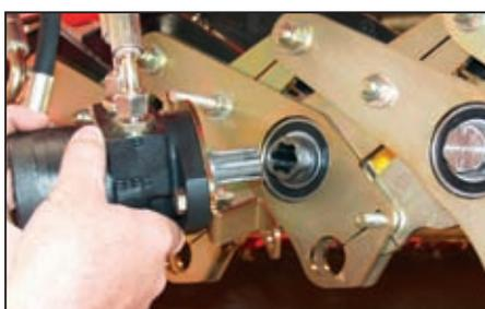
Прямой привод вальцов вместо обычных, требующих частого технического ухода, цепных приводов.
