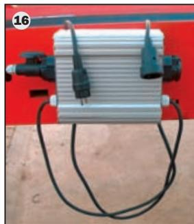
Полный контроль: с помощью системы FLOW-CONTROL (15) возможен запуск и остановка всей линии для закладки на хранение через центральный пульт управления. Все машины производства Grimme можно включить в систему управления FLOW-CONTROL. – По желанию также, машины иных производителей. Для этого требуется: устройство AFG-Box (16), с помощью которого возможно их подключение в линию без проблем.
