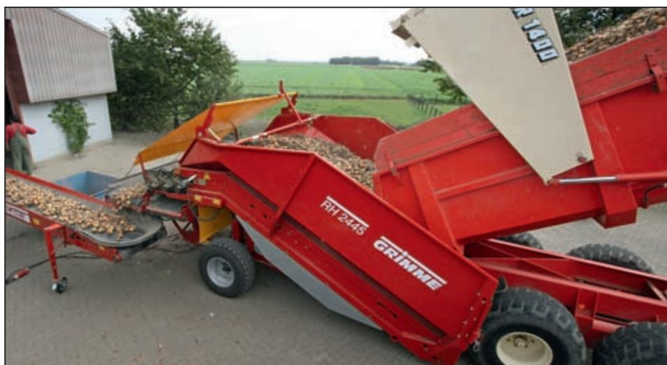
Быстрое опорожнение увеличивает производительность: ширина загрузки 300 см облегчает подъезд к бункеру. При XXL исполнении (опция) в Вашем распоряжении находятся до 21 м³ при ширине загрузки 340 см.
