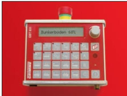
Удобное управление с помощью пульта GBT, с которого можно производить все важные установки – например, регулировку скорости движения донного транспортера бункера.
