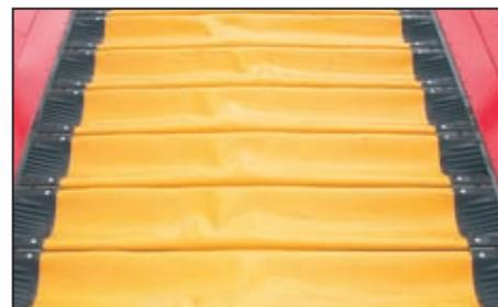
*Максимальная производительность: с помощью донного транспортера бункера, имеющего форму глубоких ламелей, достигается оптимальная эффективность транспортировки продукта и, тем самым, максимальная загрузка бункера. – Глубокие, мягкие карманы полотна транспортера обеспечивают бережное обращение с продуктом, равномерную разгрузку с минимальным обратным скатыванием продукта, а также быстрое очищение от остатков.*
