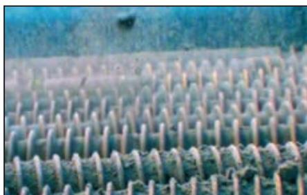
Отличная очистка: в качестве допоснащения возможно оборудование системой быстрой очистки вальцев TURBO-CLEAN. С помощью максимального числа оборотов вальцов и возникающей при этом центробежной силы производится тщательная очистка вальцов. – Идеальное решение для липких почв.
