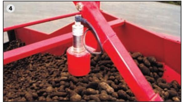
CAPACITY-CONTROL – система автоматического регулирования скорости движения дна бункера – обеспечивает оптимальную загрузку линии. Ваши преимущества: эффективное использование машины без дополнительных регулировок. Управление осуществляется посредством ультразвукового датчика.
