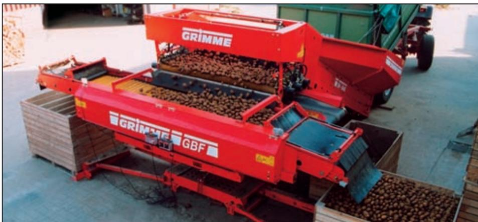
В комбинации ещё лучше: приёмный бункер Grimme RH 16-40 с интегрированным модульным устройством для заполнения контейнеров серии GBF. При этом оптимизируется поток продукта на коротком участке и исключаются излишние перепады – и все это при простом управлении и оптимально бережном обращении с продуктом.
