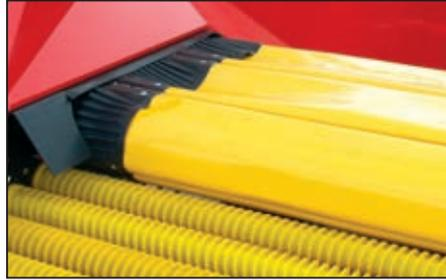
Множество преимуществ одновременно: изгиб в конце дна бункера растягивает поток продукта, улучшает равномерную передачу продукта на секцию землеотделяющих вальцов и обеспечивает непрерывное заполнение последующих машин.
