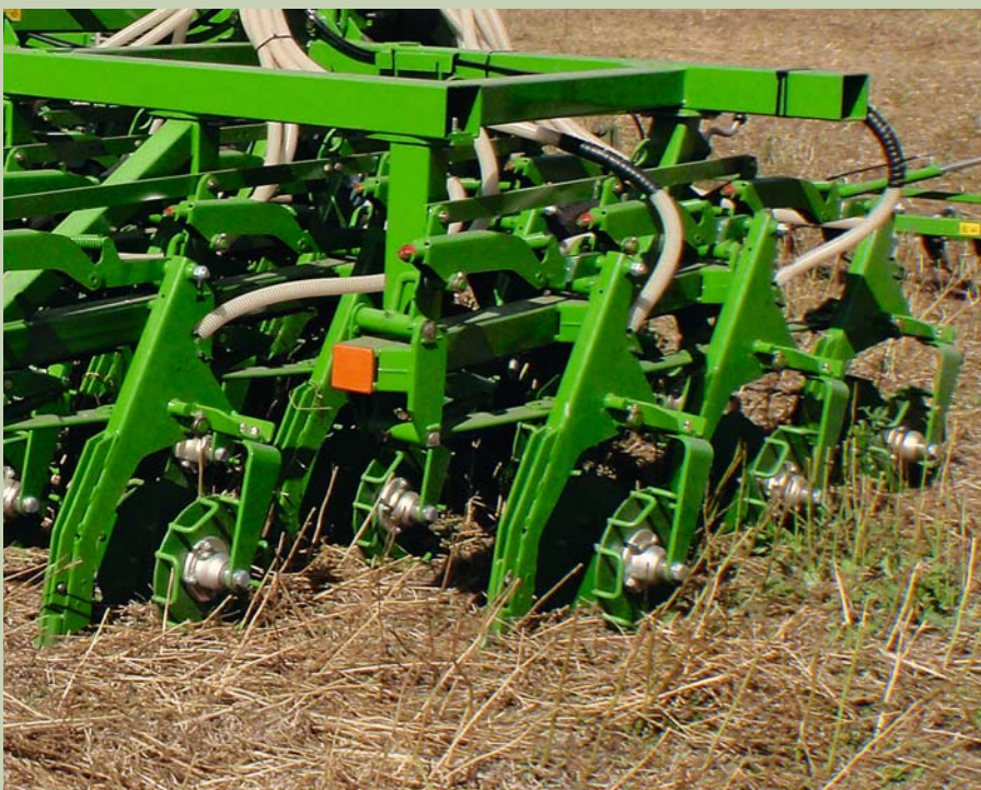
Рамочный каток для мульчированного и прямого посева
