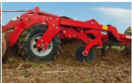
Колёсный почвоуплотнитель: Равномерное по глубине и щадящее давление на почву
