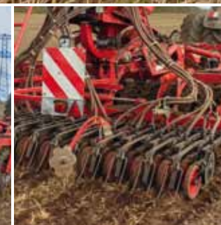
Модуль с сошниками TurboDisc Ширина междурядий 15 см, интегрированная амортизация, бесступенчатое регулирование давления до 120 кг/сошник
