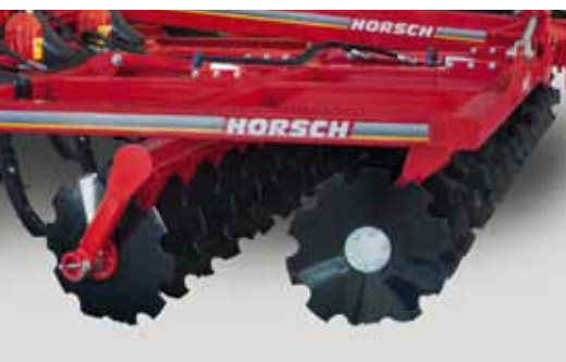
Тяжелая система дисков (DiscSystem) Двухрядное расположение, диаметр дисков 68 см, расстояние между дисками 40 см, диски с крупными вырезами и индивидуальным креплением
