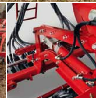
Pronto TD Удобное регулирование глубины заделки семян с помощью алюминиевых упоров
