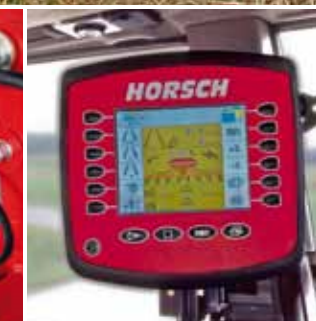
ISOBUS совместимый рабочий компьютер Электронное управление всеми функциями машины
