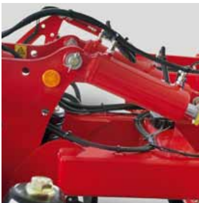
Регулирование глубины обработки: Путем ограничения хода штоков гидроцилиндров посредством удобных алюминиевых упоров
