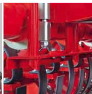
Выходы посевного материала из семяпроводов Располагаются посередине перед каждым двумя соседними колесами почвоуплотнителя
