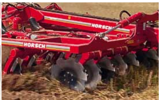
Двухрядная система дисков (DiscSystem): Эффективно прорезает и измельчает даже толстый слой крупностебельных пожнивных остатков
