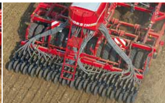
Pronto TD: Навесная универсальная сеялка с дисковыми сошниками TurboDisc
