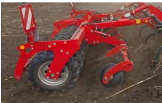
Выравнивающие диски: Равномерное выравнивание перед колёсным почвоуплотнителем
