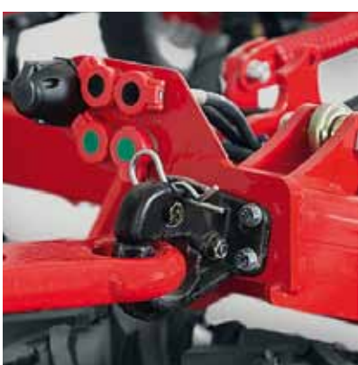
Задний фаркоп с местами подключения разъёмов гидро - и электросистем
