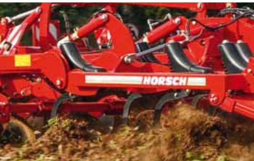
Пружинная защита стоек TerraGrip высота отклонения до 30 см, усилие срабатывания 500 кг, не требует обслуживания
