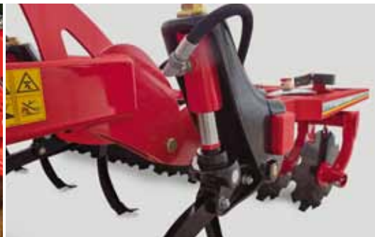
Гидравлическая защита стоек TerraGrip с усилием срабатывания более 800 кг (опционально Tiger 5, 6, 8 AS)
