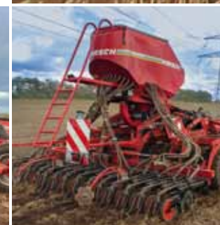
Pronto TD бункер для семян на 2.000 л, дозатор, вентилятор
