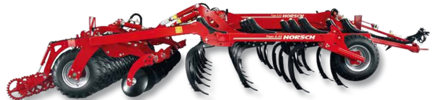
Tiger AS Четырёхрядная рамная конструкция, шаг следа лап 23 см, высота рамы 85 см, однорядные выравнивающие диски, колёсный почвоуплотнитель и каток TopRing
