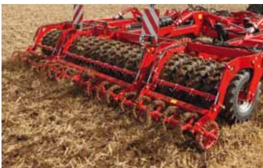
Каток TopRing: Последний штрих при подготовке почвы к посеву
