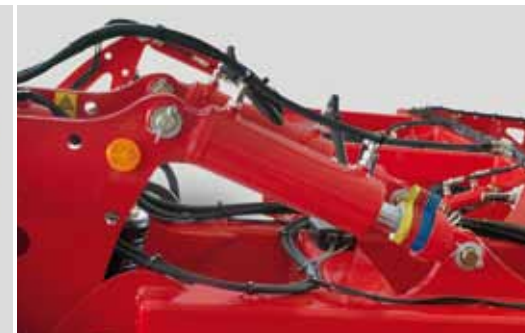
Регулирование глубины обработки Путем ограничения хода штоков гидроцилиндров посредством удобных алюминиевых упоров
