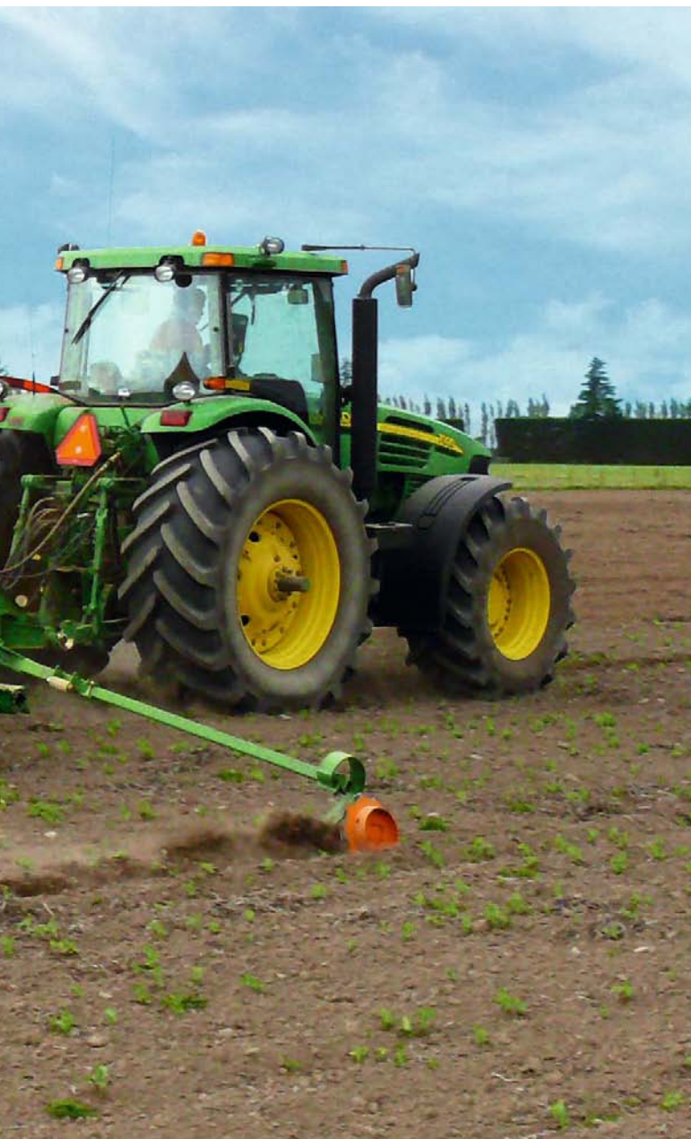
Сошники с принудительным заглублением PasTeC и защитой от перегрузок следуют по определённой борозде, уплотнённой колёсами-катками.
