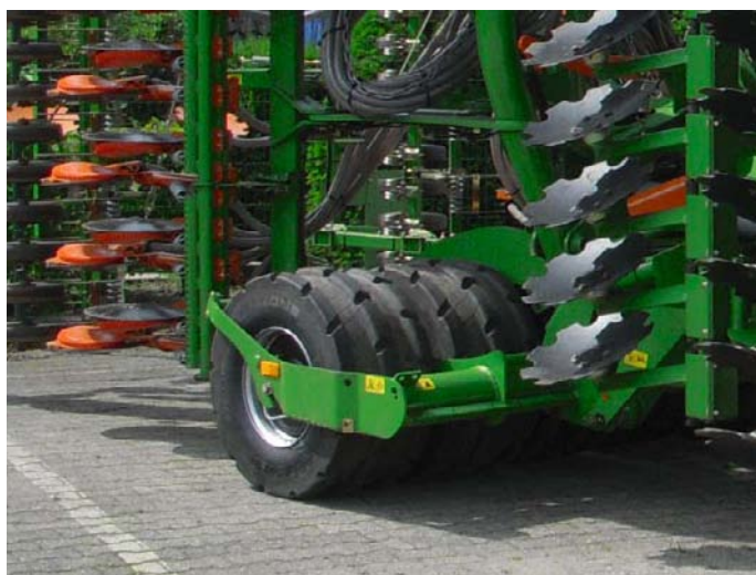
Шины шасси, заполненные полиуретаном
