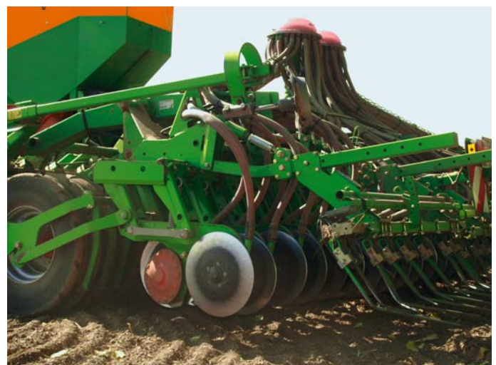
Сошники с принудительным заглублением PasTeC и защитой от перегрузок следуют по определённой борозде, уплотнённой колёсами-катками.
