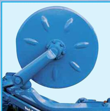
Гладкий дисковый нож диаметром 500 мм имеет боковые канавки по линии радиуса. Таким образом, обеспечивается его постоянный привод даже при наличии большого количества органической массы на поле. Установка рабочей глубины производится посредством вертикального поворота стойки дискового ножа, которая регулируется с помощью винта и зубчатого крепления.
