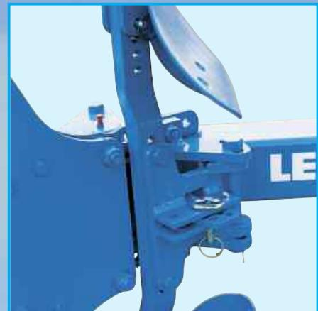
По желанию заказчика плуги Евродиамант и Варидиамант без системы автоматической защиты от перегрузок могут быть оснащены устройством быстрого изменения угла атаки каждого предплужника отдельно без инструментов. С помощью этого устройства точно регулируется место попадания в борозду органической массы.
