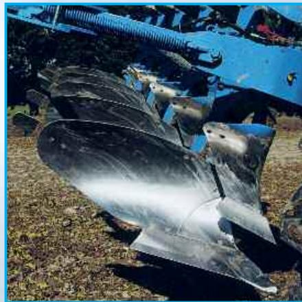
Башмак корпуса изготовлен из высококачественной термически обработанной стали и поэтому отличается высокой прочностью. Угол атаки корпусов регулируется, что обеспечивает всегда хорошее вхождение плуга в почву. Гладкий переход от лемеха к отвалу создает гармоничную форму, что обеспечивает минимальное тяговое сопротивление плуга.
