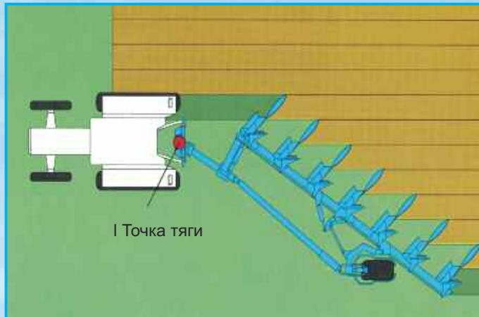
Точка тяги заранее установлена и находится перед системой нижней навески. Благодаря такому расположению точки тяги обеспечивается идеальная линия тяги "трактор-плуг". Тем самым уменьшается боковое давление на полевые доски, экономится топливо, независимо от ширины захвата.
