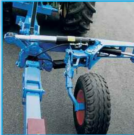
Переднее поворотное опорное колесо при вспашке вне борозды движется в пределах рамы плуга. Таким образом, выдерживается необходимое для разворота на меже большое свободное пространство. Для вспашки в борозде колесо фиксируется в центральном положении, поэтому его демонтаж не требуется.
