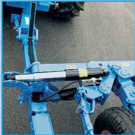
В зависимости от вида трактора или типа колес полунавесной оборотный плуг можно из кабины трактора при помощи гидравлики настроить на работу, как в борозде, так и на вспашку вне борозды.
