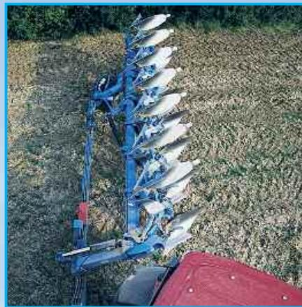
Большое расстояние между трактором и 1-м корпусом плуга обеспечивает высокую маневренность без риска повреждения колеса трактора об рабочие части плуга (угол разворота трактора относительно плуга до 90 градусов).
