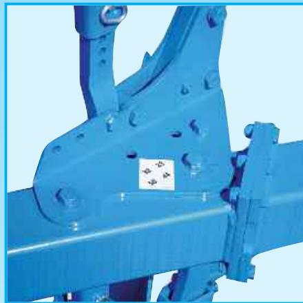
Прочная рама четырехгранного профиля, выполненная из микролегированной мелкозернистой стали, обеспечивает легкость конструкции, высокую прочность и длительный срок службы. Рама может быть удлинена с помощью фланцевого соединения. Кронштейны для ступенчатого изменения ширины захвата корпусов на Евродиаманте привинчены к раме с помощью болтов. Ширина захвата устанавливается перестановкой центрального болта и регулируется на 4 ступени в диапазоне от 30 до 50 см.
