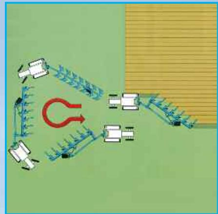
Взаимодействие обратного механизма и шарнирной подвески колеса позволяет даже на холмистой и труднопроходимой местности быстро и просто разворачивать плуг на узкой полосе.
