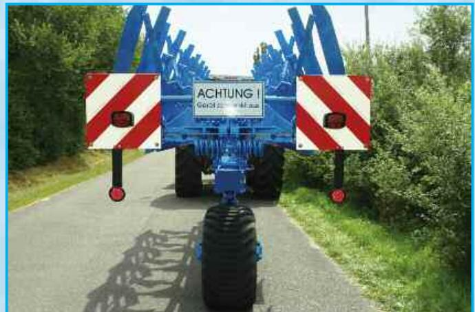
Для быстрой и безопасной транспортировки плуг поднимается в среднее положение и стопорится запорными кранами. Он надежно транспортируется с трактором как одноосный прицеп. Таким образом, трактор и плуг эффективно защищены от перегрузок.
