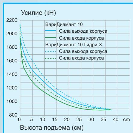
Мягкий, без толчков выход корпуса плуга из почвы при помощи двойных пружин сжатия или гидроцилиндра. Запатентованная роликовая система обеспечивает медленное снижение усилия при выходе плуга из почвы и соответственное возвращающее усилие при повторном заглублении. Значительные усилия при выходе плуга из почвы и при повторном заглублении делают возможным устойчивое ведение корпуса и бесперебойную работу на каменистых почвах.
