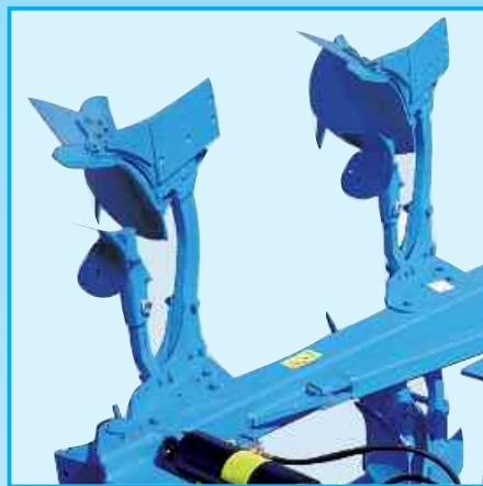
Установка плужных корпусов сбоку рамы и новейшая форма стоек создают необычайно большое свободное пространство между корпусами, предотвращая таким образом забивание плуга поживными остатками даже при минимальной ширине захвата плуга.
