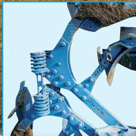
У плугов Евродиамант и Варидиамант, оснащенных системой автоматической защиты от перегрузок, существует возможность ступенчатого изменения расстояния между предплужниками и основными корпусами с помощью болтов. Установка рабочей глубины предплужников осуществляется без инструментов – штифтами. По желанию заказчика устанавливаются специальные стойки для фиксации предплужников, что также позволяет изменить угол атаки предплужников.
