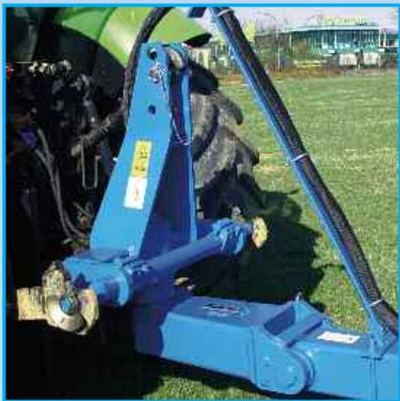
Башня плуга имеет цельный и эластичный вал навески категории II или III. Воспринимая большие ударные нагрузки, вал защищает трактор и башню. Башня крепится к раме при помощи оси, изготовленной из высококачественной стали, прошедшей термическую обработку. На оси закреплены два роликовых подшипника, доступных для смазки. Особая прочность и длительный срок службы гарантированы.
