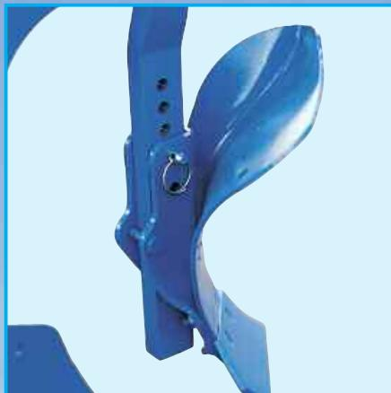
Крепление предплужников на плоские стойки исключают непроизвольное отключение предплужников в сторону. Все типы лемехов и отвалов предплужников взаимозаменяемы, так как башмаки корпусов всех предплужников идентичны. Если требуется использование плуга без предплужников, то демонтируются они очень быстро путем снятия двух болтов на стойке.
