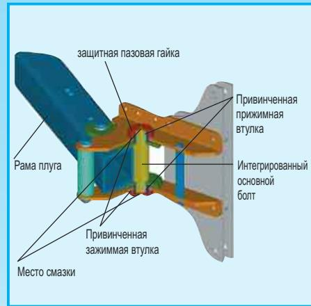
Основные болты шарнирных соединений оснащены зажимными втулками и надежно закреплены между пластинами рамы, что делает невозможным их скручивание. Сам кронштейн также оснащен прижимными втулками. Таким образом, обе находящиеся одна в другой смазывающиеся втулки гарантируют долгий срок работы опор даже в самых тяжелых условиях. В случае износа каждая деталь отдельно заменяется.
