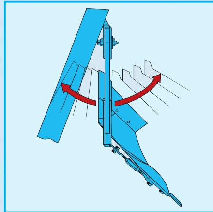
При встрече с препятствием упругие стойки корпусов и грэдилей, изготовленные из высококачественной термически обработанной стали, отклоняются далеко в сторону. При этом грэдили настолькоочноочно закреплены, что их выход из опорных узлов не возможен.
