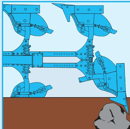
Даже если острое лемеха попадет под камень, крупный корень дерева или скальное образование, то это не проблема, поскольку все плуги производства фирмы ЛЕМКЕН серийно оснащаются срезными предохранителями. Таким образом, конструкция крепления корпусов в любом случае защищена от повреждений. Срезной предохранительный болт можно быстро заменить и продолжать работу.
