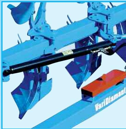
Пластины рамы, на которые крепятся кронштейны для бесступенчатого изменения ширины захвата привинчены к раме с помощью болтов. Благодаря этому повышается точность сборки рамы, ее прочность и устойчивость к динамическим нагрузкам. Шарнирные соединения расположены вблизи корпуса вне рамы, что позволяет максимально разгрузить подшипниковые узлы и комплектующие плуга. Бесступенчатая установка ширины захвата производится гидравлическим цилиндром двойного действия.
