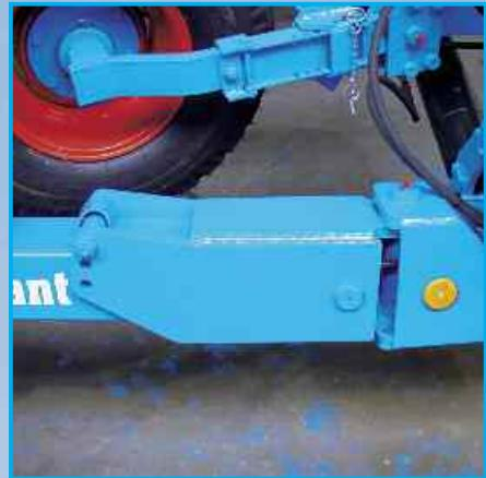
Горизонтальная линия тяги легко регулируется по высоте при помощи перестановки пальца. Благодаря этому задняя ось трактора может быть целенаправленно нагружена. При применении с гусеничными тракторами линия тяги смещается вниз для равномерного распределения нагрузки на ленты гусениц. Таким образом, со всеми тракторами достигается оптимальная передача силы тяги с минимальной пробуксовкой.
