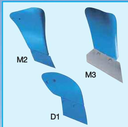
Специальные предплужники D1, M3 и M2 обеспечивают чистую поверхность вспашки даже при большом количестве органической массы. Установка рабочей глубины предплужников производится легко и быстро с помощью забивного штифта. Ряд отверстий на стойках позволяет производить точную установку всех предплужников по глубине, что обеспечивает одинаковое качество работы. Предплужники D1 и M2 по желанию заказчика могут быть укомплектованы удлинителями отвалов.
