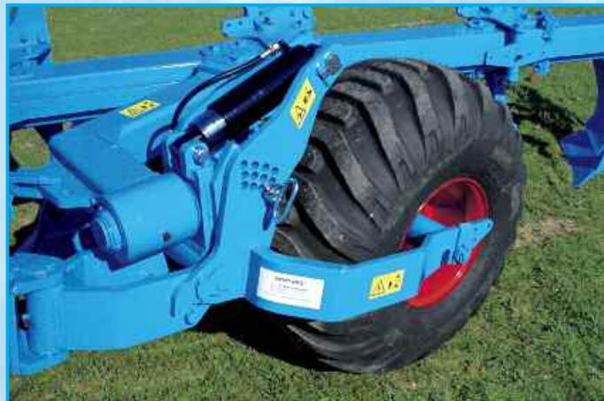
Широкопрофильное опорное колесо уменьшает давление на почву при пахоте и гарантирует необходимую безопасность при транспортировке.
