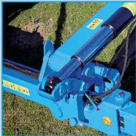
С целью защиты от повреждений гидравлические шланги подсоединения к трактору помещены в брезентовый рукав. Шланги регулировки ширины захвата и подъема опорного колеса находятся внутри рамы стабилизатора, что эффективно защищает их от повреждения и загрязнения.
