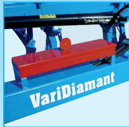
Плуги производства фирмы ЛЕМКЕН легки в обслуживании. Инструменты, предохранительные срезные болты и другие мелкие детали всегда под рукой, в ящике для инструментов.
