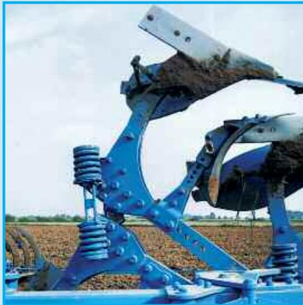
На роликах, движущихся между сдвоенными грэдилами, ни при выходе корпуса из почвы, ни при повторном вхождении в неё существенных сил трения не возникает. Это означает, что потери усилия при повторном заглублении корпуса плуга в почву снижены до минимума. Результатом этого является равномерная характеристика срабатывания: мягкий, без толчков выход корпуса плуга из почвы и энергичное, быстрое повторное заглубление корпуса.
