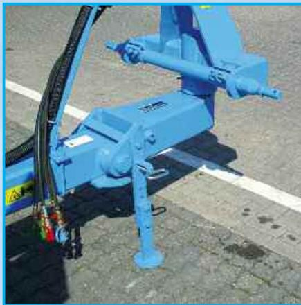
Опорная стойка, регулируемая по высоте, обеспечивает легкое агрегатирование с трактором. При помощи пружинного болта стойка быстро переводится в рабочее или транспортное положение.
