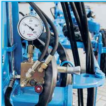
С помощью маховика на блоке управления можно установить возможный диапазон регулировки давления между 50-140 бар:
