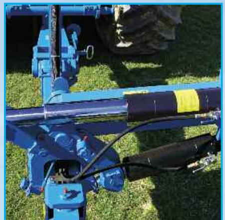
Два телескопических гидроцилиндра обеспечивают быстрый и безударный оборот плуга на 180 градусов. Точную регулировку позиции наклона плуга в борозде осуществляют с помощью регулировочных болтов отдельно для каждой стороны.
