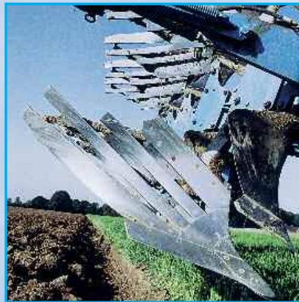
Полосовой корпус состоит из отдельных толстых полностью прокаленных полос, изготовленных из специальной высококачественной стали, которые при износе можно менять отдельно. Головки крепежных болтов глубоко утоплены в посадочные гнезда, что обеспечивает тугую посадку полос даже после долговременного использования. Полосовые отвалы, также как и обычные, крепятся на одну и ту же корпусную основу.
