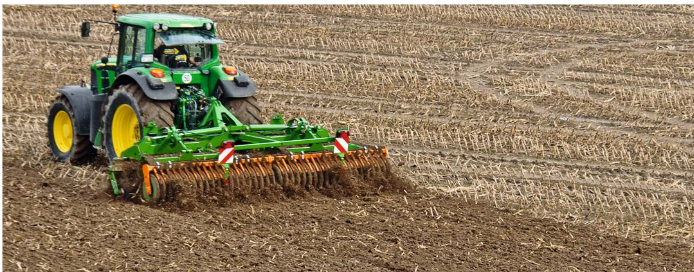
Диски Catros+: толщина 5 мм, диаметр 51 см
