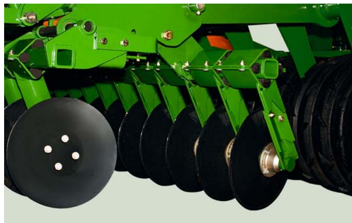
Диски Catros: толщина 4 мм, диаметр 46 см
