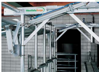
Пневмоцилиндры на фронтальной решетке
