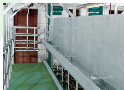
Широкий защитный «отбойник-туалет» из нержавеющей стали
