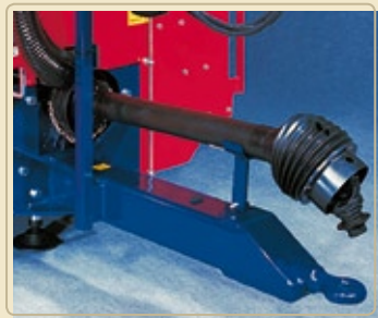
Нижняя подвеска и карданный вал с большим углом действия
